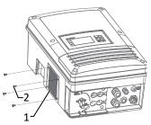
Fig. 62: Removing the fan
