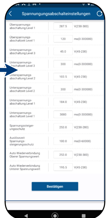
Abb. 99. Spannungsbereich und Abschaltzeiten definieren
